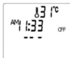
Fig. 8: Preriscaldamento disattivato
